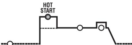
В режиме MMA соответствует динамической перегрузке по току "HOT START" (регулировка 0 ÷ 100%). С указанием на дисплее процентного увеличения относительно предварительно выбранного значения сварочного тока. Эта регулировка повышает плавность сварки.
