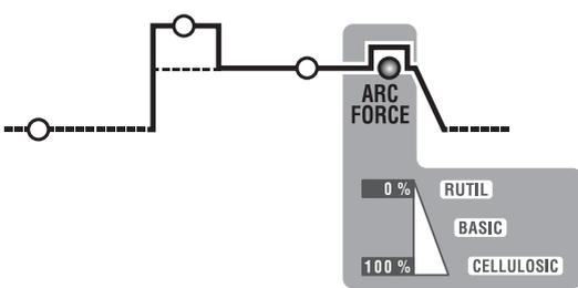
В режиме MMA соответствует динамической перегрузке по току "ARC-FORCE" (регулировка 0 ÷ 100%) с указанием на дисплее процентного увеличения относительно предварительно выбранного значения сварочного тока. Эта регулировка повышает плавность сварки и позволяет избежать прилипания электрода к детали.
